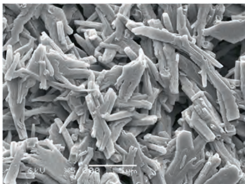
Figuur 2 - \text{NaHCO}_3 gekristalliseerd onder eutectische condities.
